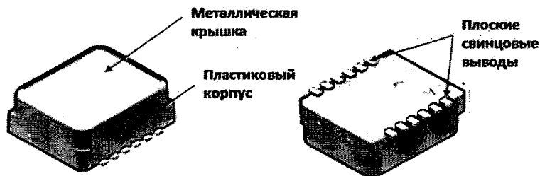
Рис. 36. Конструкция корпуса акселерометра
