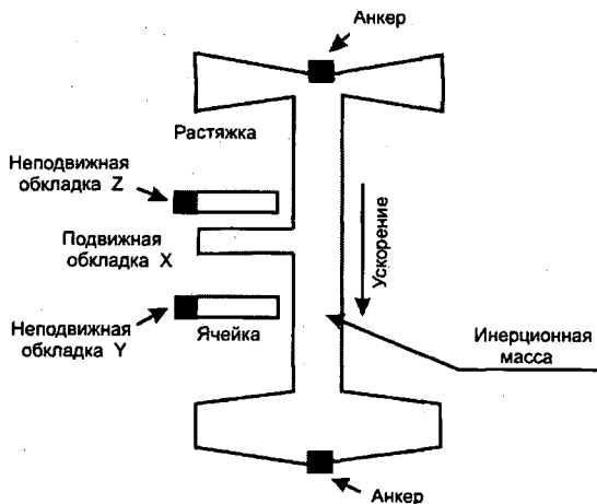
Рис. 37. Принцип действия емкостного акселерометра
