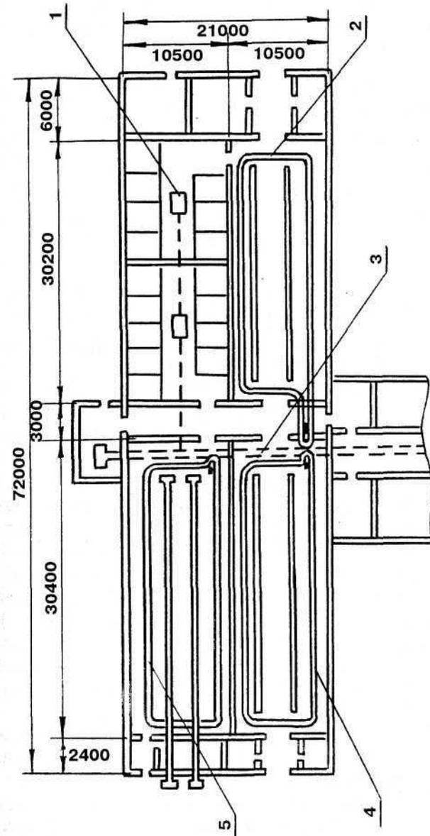
Рис. 10. Схема размещения оборудования для уборки навоза в цехе отела: 1 — трапы и трубопровод канализации профилактория; 2 — навозный транспортер ТСН-2 предродильного отделения; 3 — навозный транспортер ТС-1; 4 — навозный транспортер ТСН-2 послеродильного отделения; 5 — навозный транспортер ТСН-2 отделения отела
