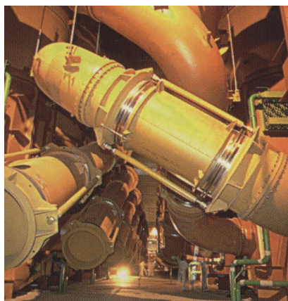
Рис.5.2. Элементы каскада французских диффузионных машин
