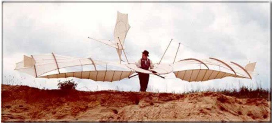
Рис. 1.2.- Планер конструкции Лилиенталя
