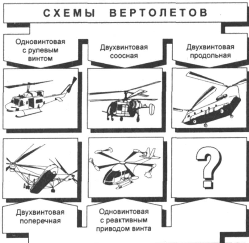
Рис. 6.13.- Классификация вертолетов по способу компенсации реактивного момента несущего винта
