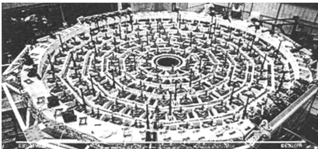
Рис. 2.62. Оправа 8,2-метрового главного зеркала очень большого телескопа (VLT) Европейской южной обсерватории. В нижнюю поверхность зеркала упираются 150 управляемых «домкратов», которые по командам компьютера поддерживают форму зеркала в состоянии, близком к идеальному
