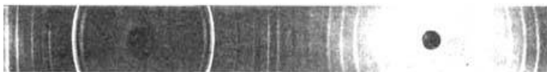
Рис. 4.43. Дебаеграмма соединения CuZn_3 , снятая по методу Шеррера и Дебая
