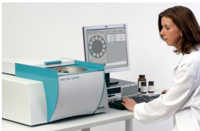
**Рис. 1.13.** Рентгеновский спектрометр
