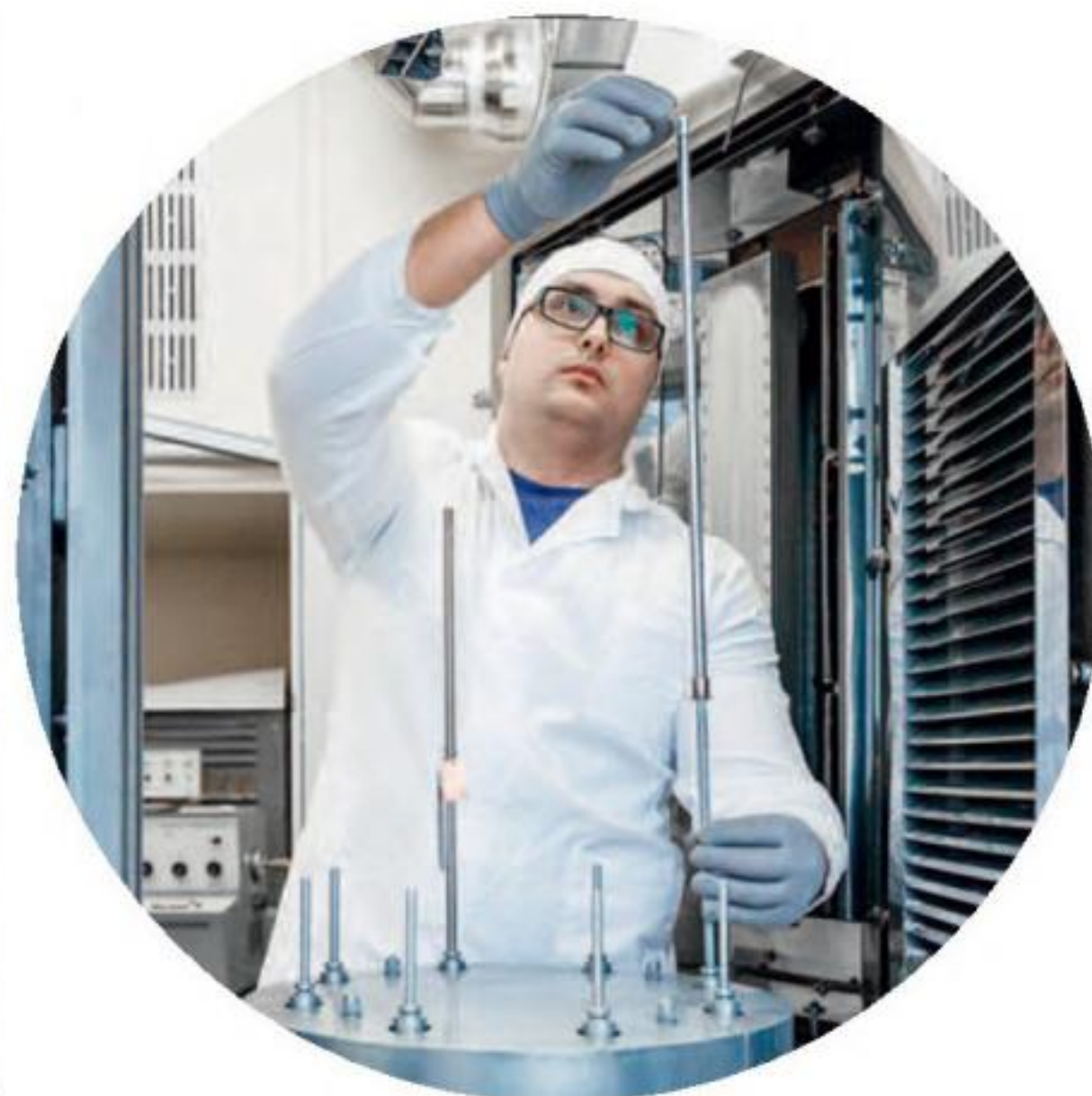
Загрузка оболочек в механизм вакуумной установки для напыления защитного покрытия.
