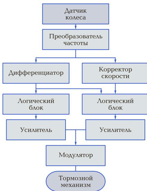
Рис. 5.6. Структурная схема управления ABS
